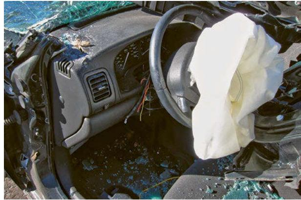
**Abbildung 1-4:** Heben Sie den kollabierten Airbag an und kontrollieren Sie, ob das Lenkrad deformiert ist.
